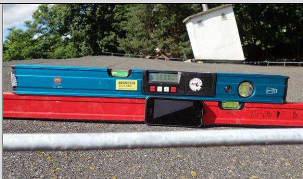
Fot. Z_55, Z_58. Zmierzone nachylenie dachu 36% do 38,5% (ok 20°).
