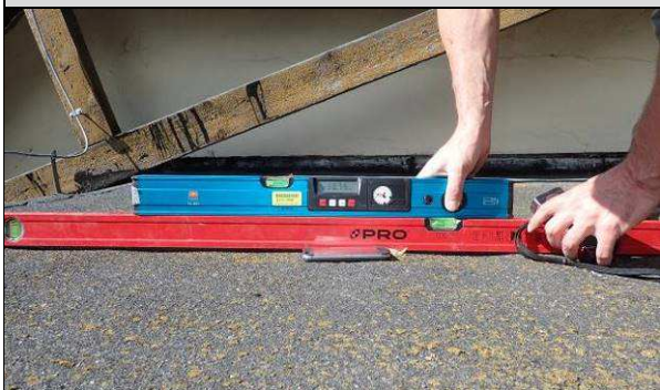
Fot. Z_55, Z_58. Zmierzone nachylenie dachu 36% do 38,5% (ok 20°).
